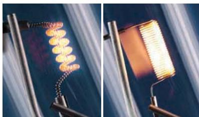
OSRAM TRUCKSTAR® — благодаря новому способу намотки спирали (фото вверху справа), на который получен патент, технология «Single-Coil» обеспечивает увеличение срока службы ламп головного света OSRAM TRUCKSTAR® до 100%<sup>2)</sup> по сравнению с традиционными биспиральными лампами (фото вверху слева).
