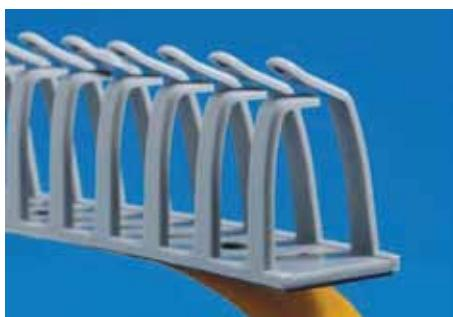
Удобен в применении при переходе с одной плоскости на другую. Гибкий канал используется в щитах рамной конструкции, приклеивается непосредственно на поверхность рам и на обратной стороне передних панелей щитового оборудования для разводки проводов к светосигнальной арматуре (кнопки, переключатели и пр.). При этом не рекомендуется использовать его на дверях, где постоянные движения плоскостей.
