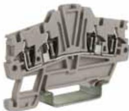
Подключение проводов осуществляется с помощью пружины, форма которой позволяет обеспечить ровное пятно контакта. Применение данного типа зажимов целесообразно когда прокладывается большое количество кабелей с сечением от 0,2 до 25 мм<sup>2</sup> и не очень высокой силе тока.
