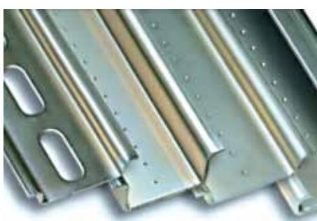
Стандартизованный металлический профиль, для установки на него различного электротехнического оборудования. Все DIN-рейки изготовлены из стали и покрыты антакоррозийным покрытием, выдерживающим 40 мин в солевом растворе.
