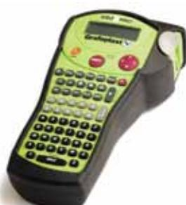
Предназначены для маркировки кабеля, проводов, коммутационных панелей, пультов управления. Пример применения: телекоммуникационные панели, маркировка щитов (например, подпись переключателей и контрольных ламп). Удобно маркировать патч-панели и сетевые кабели. С его помощью монтажник может осуществлять печать маркировочных элементов "на месте".
