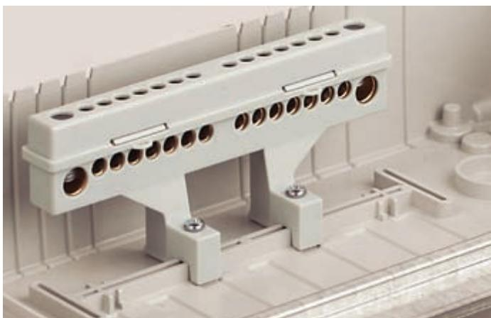
Клеммный блок крепится поставляемыми в комплекте саморезами на специальные профили, расположенные на дне внутренней части щитка
